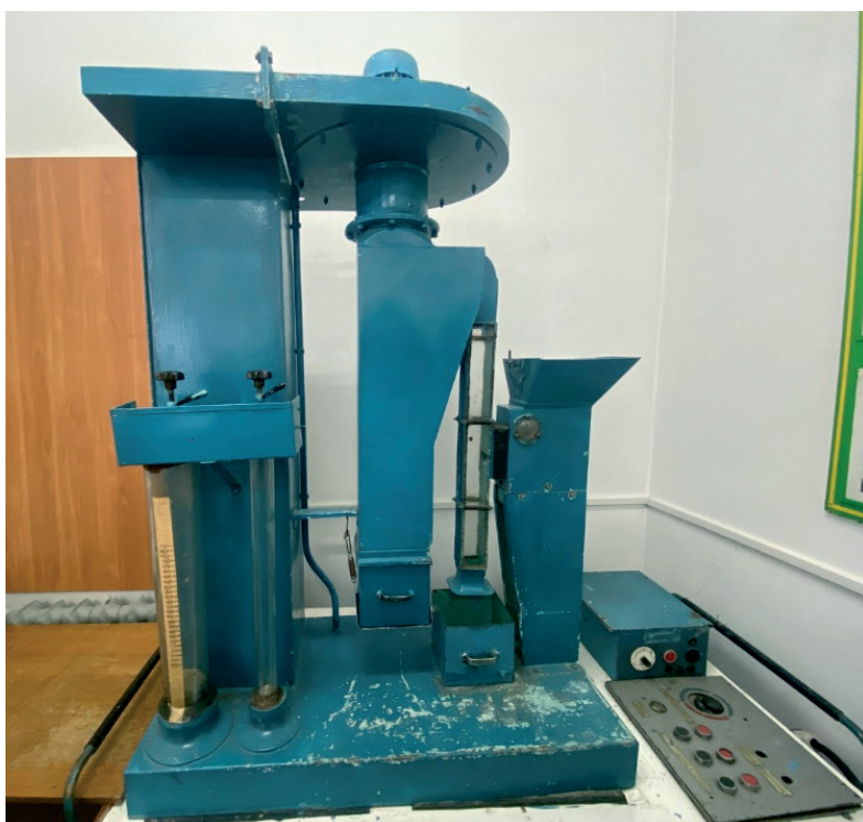
Рис. 1. Общий вид пневмоклассификатора Petkus K-293
